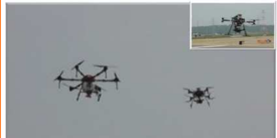
東京大学ほか ステレオカメラによる滑走路と異物検知試験
