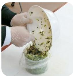
破壊式では、試料を細かくぎざみ、容器にすきまなく詰めます。
