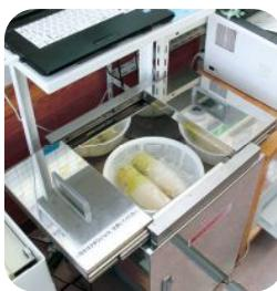
横32×縦24×深さ15cm以内の大きさであれば、形を壊さず測定できます。
