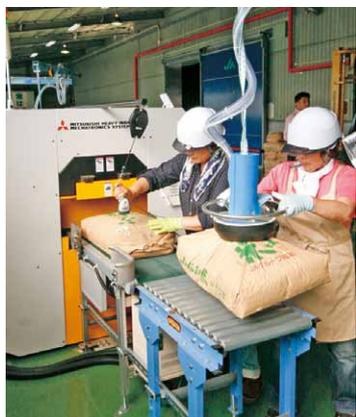
ベルトコンベア式検査機で線量を測定する様子
