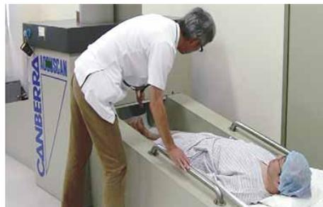
仰向け状態で測定できるベッド型ホールボディーカウンターによる検査
