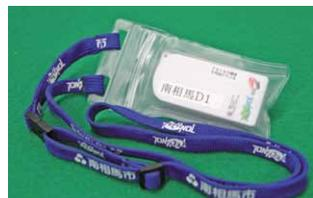
ガラスバッジと同様に首からぶらさげて放射線量を測定する小型の個人積算線量計です。
