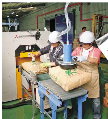
ベルトコンベア式検査機で線量を測定する様子
