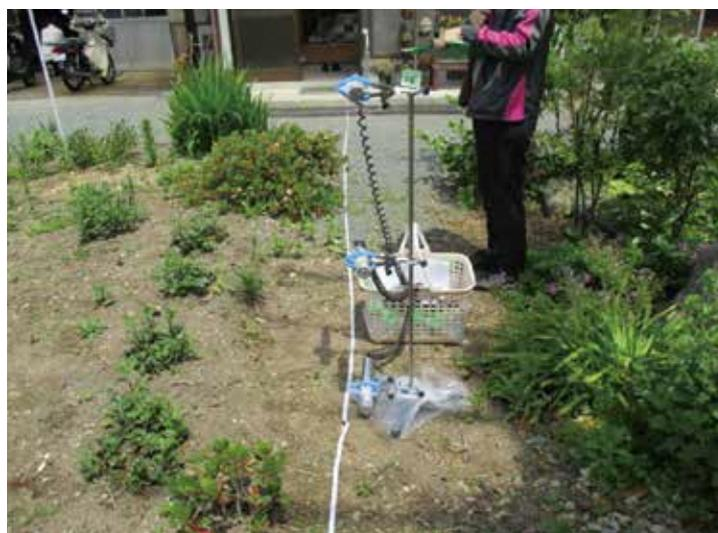
上写真：NaIシンチレーションサーベイメータによる測定の様子
