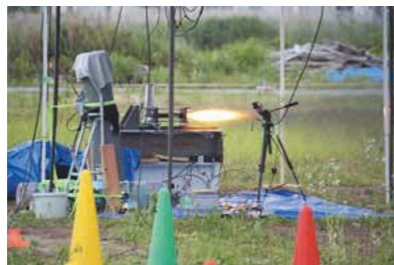
▲県立テクノアカデミー浜で小型ロケットエンジンの燃焼試験を実施。(R6.6)-AstroX(株)
