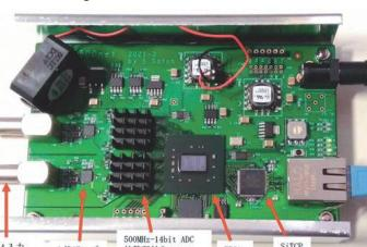
ガンマ・中性子線種弁別機能を搭載する
