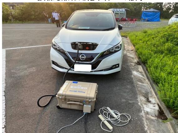
電気自動車からモバイルクーラー、移動式シャワーに給電
