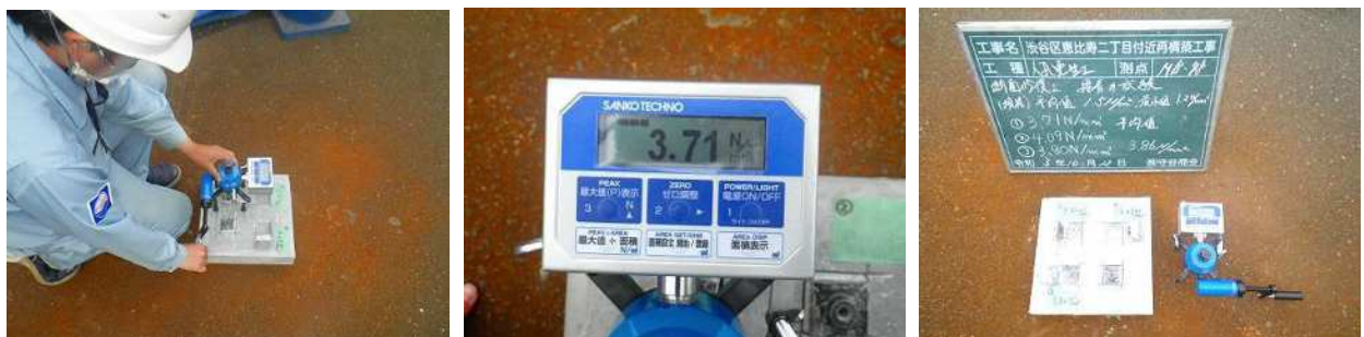
写真 4-2 断面修復材+MLR更生材 固着強度試験 (※ 写真は断面修復材のみ)
