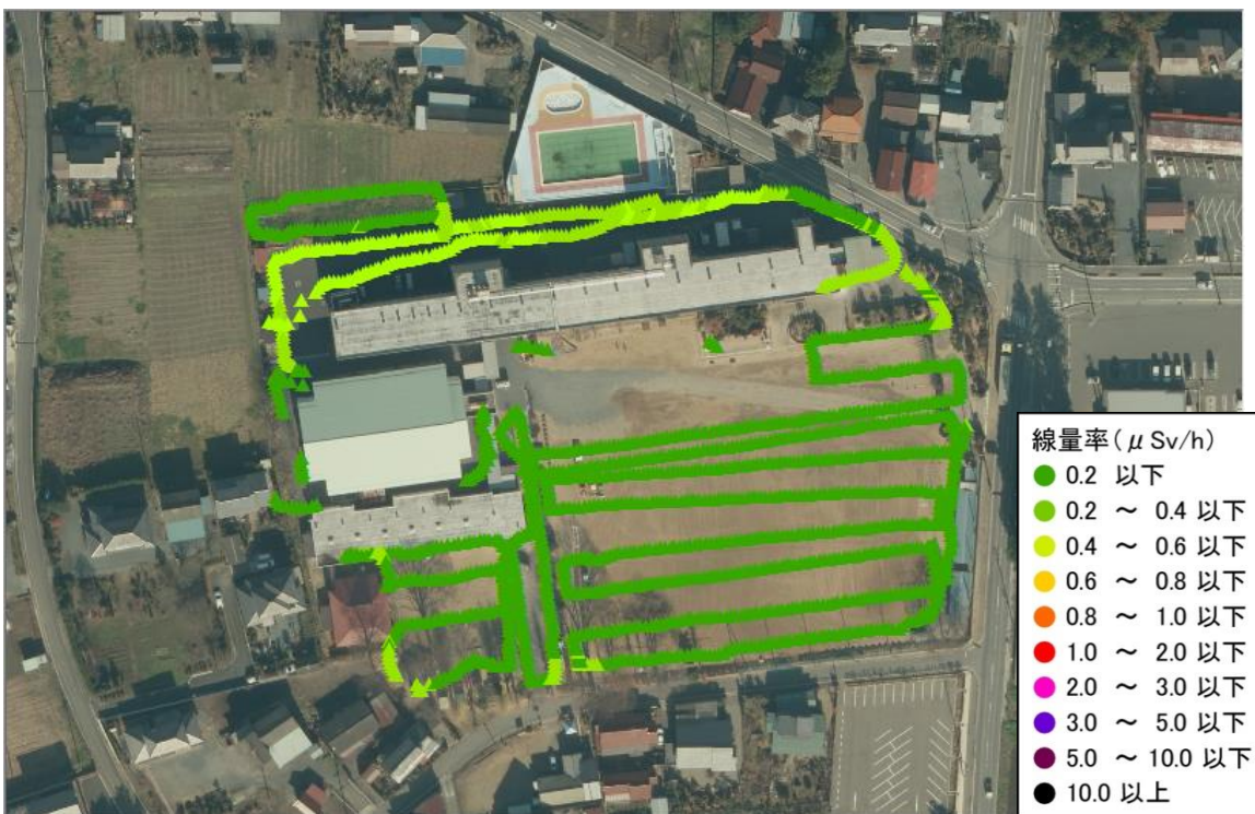
石神第二小学校と石神第二幼稚園（測定日：2014年5月30日、高さ50cm）
