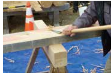
図11 ヤリガンナによる製材の様子
