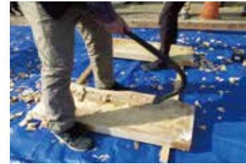
図10 チョウナによる製材の様子
