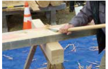
図11 ヤリガンナによる製材の様子
