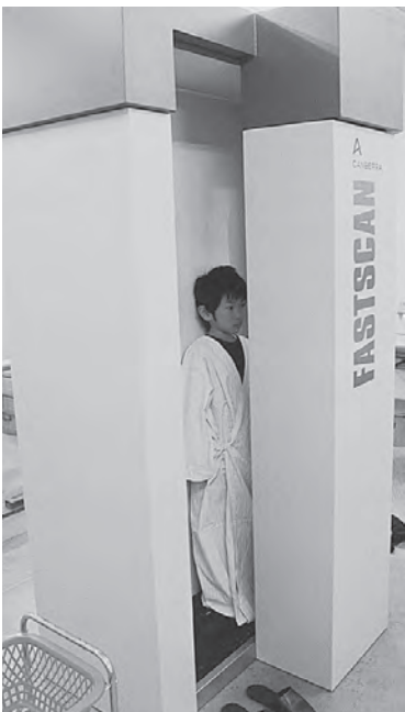
内部被曝検査を受ける小学生
