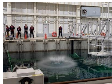
フェアリング開頭実験(インターステラテクノロジズ)
