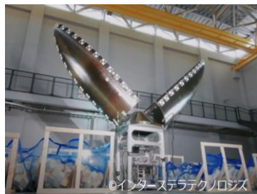
フェアリング開頭実験(インターステラテクノロジズ)
