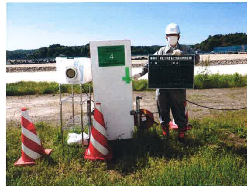
図3 敷地境界における大気中放射能濃度用ダスト採取位置とダスト採取の様子（採取位置 No. 4）
