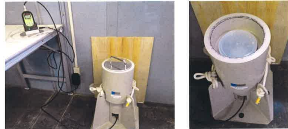
Thermo SCIENTIFIC 社 高感度ガンマ線食品モニタ SX-SPA
